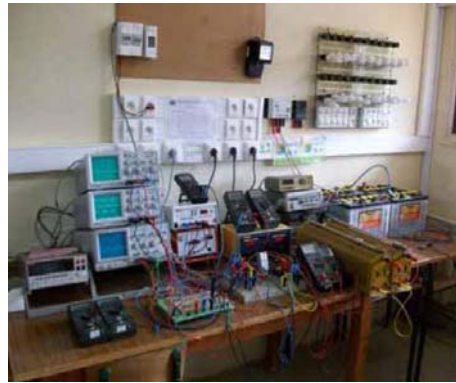
Fig. 3: Banc de mesure mis en place pour caractériser les panneaux et les systèmes photovoltaïques
