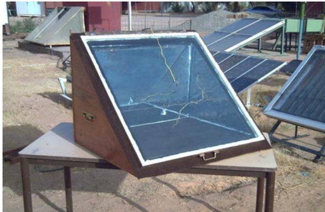
Fig. 6: Vue du dispositif expérimental de cuiseur solaire installé sur la plate forme des essais de l'URER/MS à Adrar
