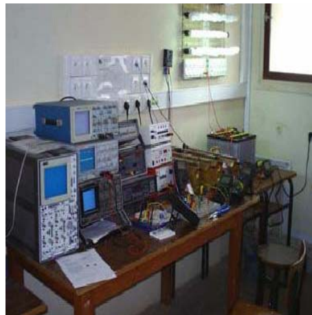
Fig. 7: Banc de mesure mis en place pour caractériser les panneaux et les systèmes photovoltaïques
