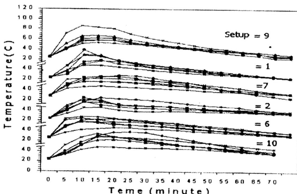
شكل 3: درجة حرارة سطح المفاعل الكيميائي خلال 70 دقيقة من أجل الحالات رقم (1، 2، 6، 7، 10)
