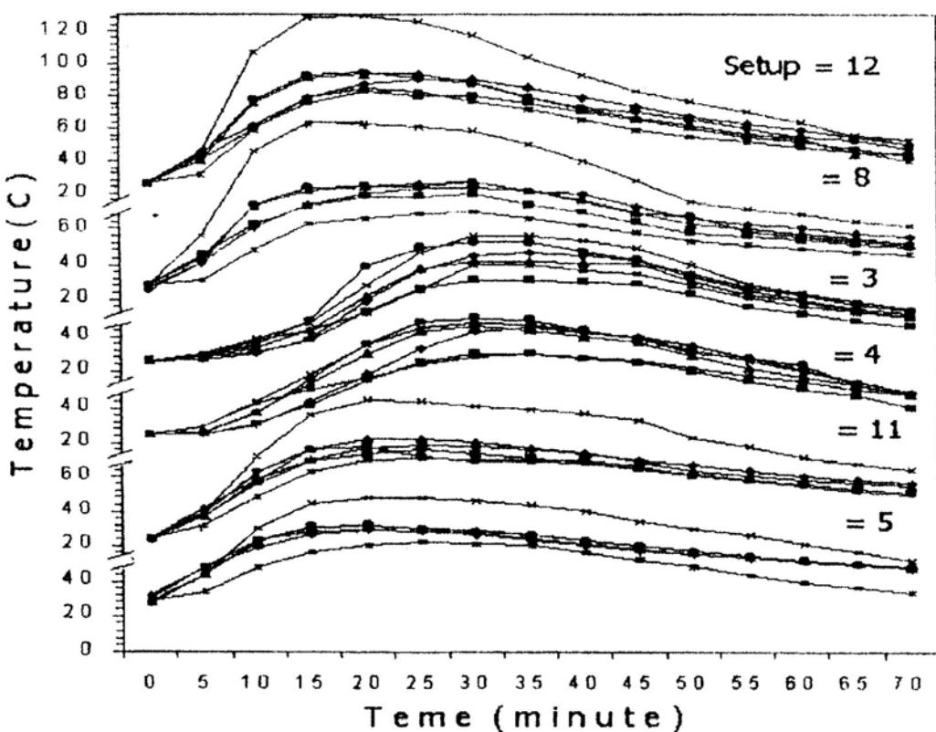
شكل 2: درجة حرارة سطح المفاعل الكيميائي خلال 50 دقيقة من أجل الحالات رقم (12,11,8,5,4,3)
