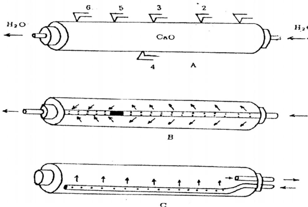
شكل 1: مخطط مواقع المجسات الحرارية و توضع أنبوب التغذية
