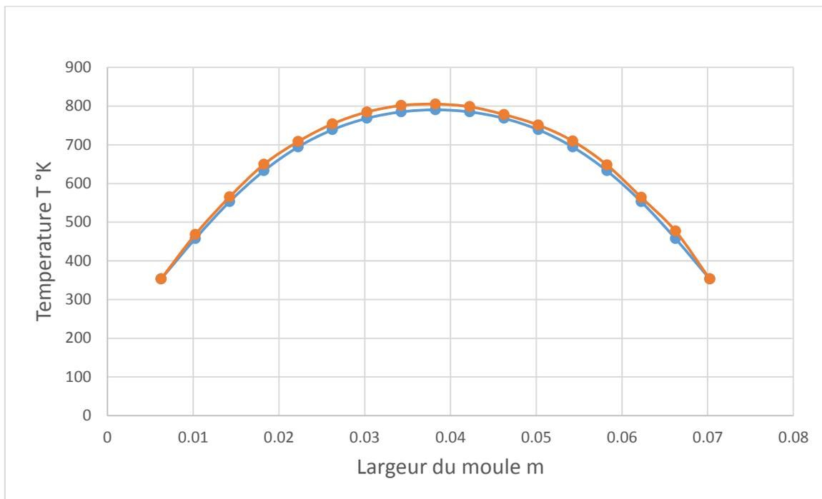
**Figure 5** : comparaison entre les résultats de la simulation par FLUENT et de la modélisation par MATLAB
