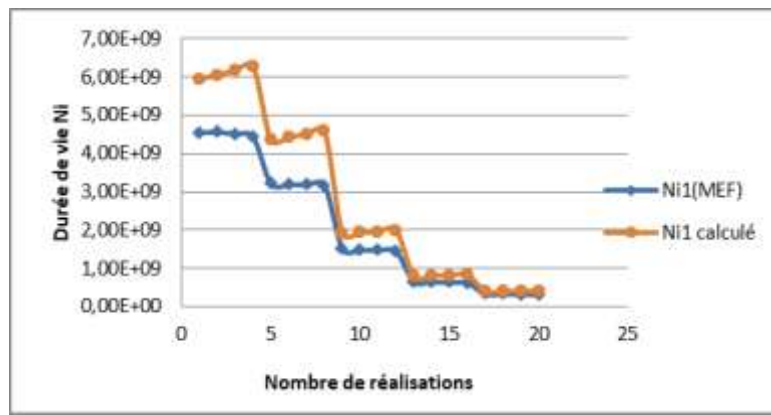
Figure 14 : Evolution de la durée de vie en fonction du nombre de réalisations.
