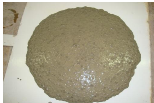
b. D = 73cm avec 35% d'addition de FC
