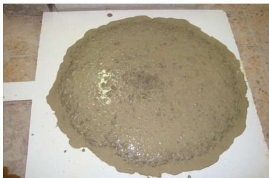
a. D = 73cm sans addition de FC (Ressuage et début de ségrégation)
