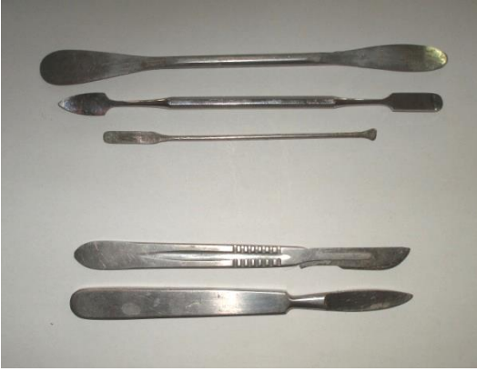
الصورة رقم: 3: مشارط وملاوق تستعمل في التنظيف الميكانيكي. عن: المؤلف.
