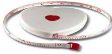
ب. شريط متري (Ruban mètre): يستخدم من اجل قياس المحيطات
