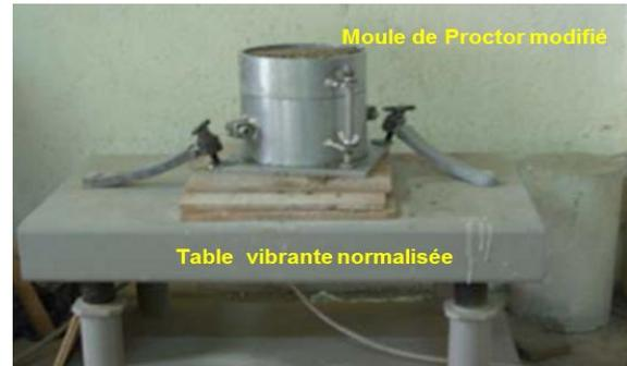
**Fig.3.** Moule Proctor modifié et table vibrante, utilisés pour le compactage du béton.
