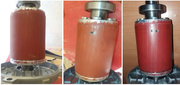
Fig. 2 – Photographie des rotors de la MAS de 3 kW pour un état sain (à gauche), une barre cassée (au centre), deux barres cassées (à droite).
