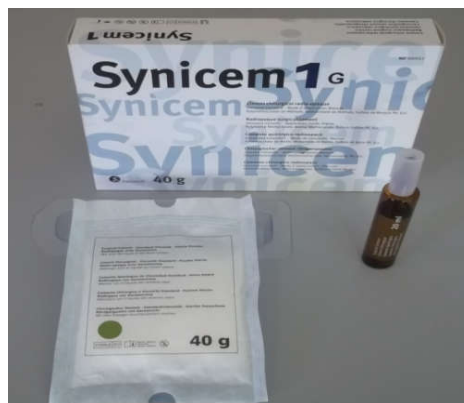
Fig. 3 – Deux composants de PMMA: poudre (polymère) et liquide (monomère) sont mélangés par une fraction de 2 g/1 ml (Synicem 1G, REF 880223).
