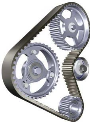
Fig.1– Transmission par une courroie dentée.
