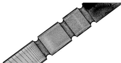
Fig. 4 – Exemple du maillage d'un cylindre avec trois imperfections.
