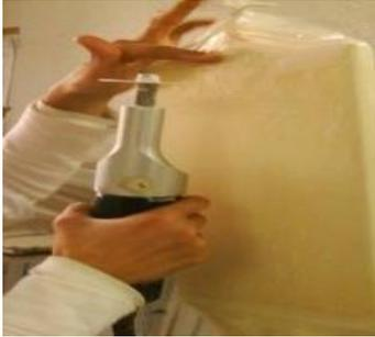
Fig.3 Découpe des éprouvette en composite.
