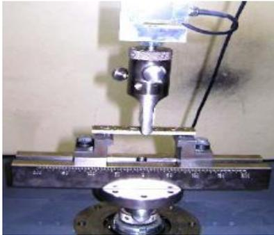
Fig. 4. Dispositif de flexion 3 points utilisé
