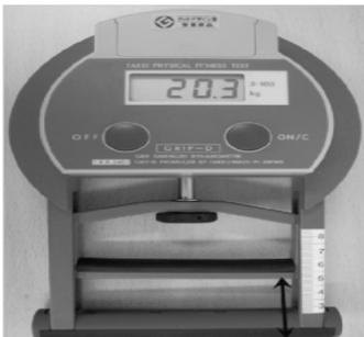
**Figure 01** : Dynamomètre TKK 5401 Grip-D, Tokyo, Japan utilisé dans l'étude
