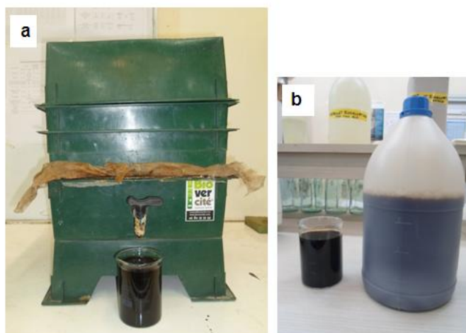
Figure 1 : Production du vermicompost brut [13] (a) Vermicomposteur à quatre compartiments avec robinet de récupération (b) Conteneur de stockage du jus de vermicompost brut
