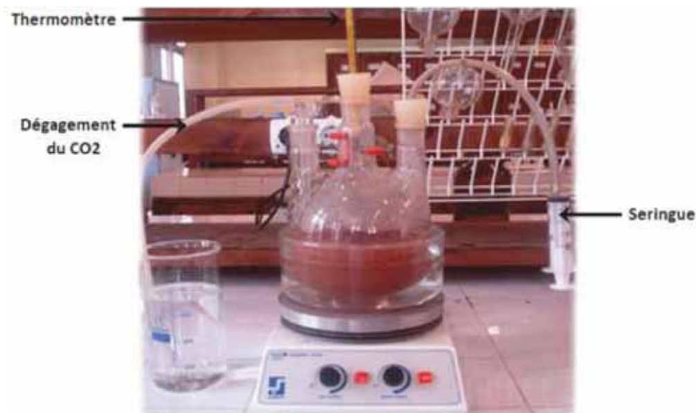
Figure 2 : Dispositif de la fermentation alcoolique
