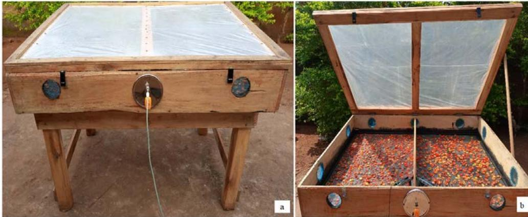
Figure 1. Photos du séchoir caisse : séchoir caisse fermé (a) ; séchoir caisse ouvert (b)
