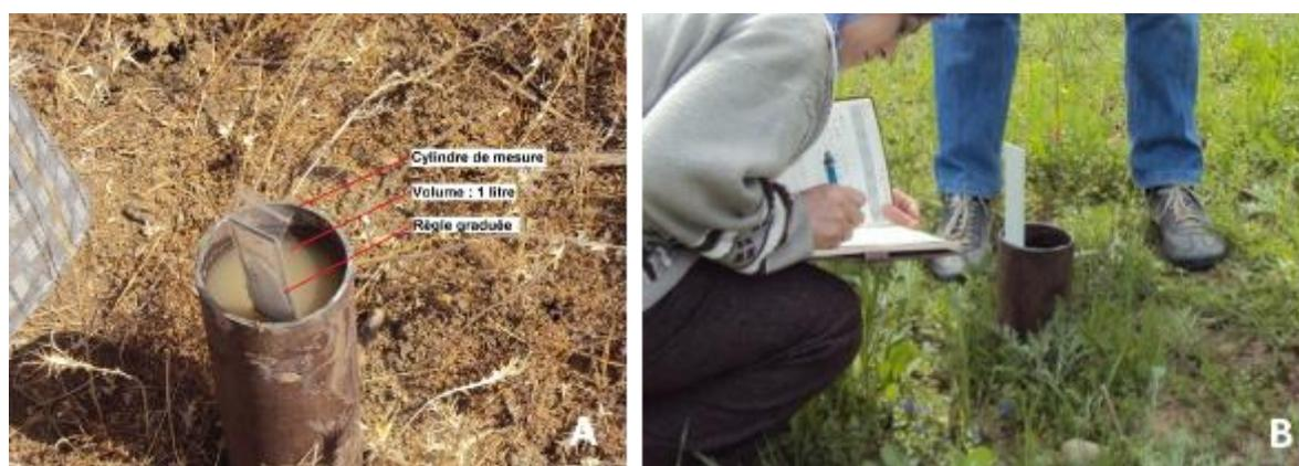
Figure 4 : Test d'infiltration au monocylindre
