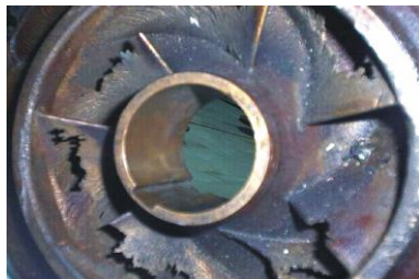
Roue fermée de la pompe centrifuge multicellulaire à axe horizontal en bronze attaquée par le phénomène de cavitation par érosion abrasive
