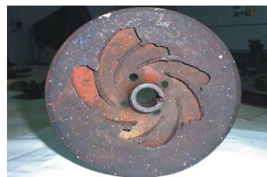
Roue fermée de la pompe multicellulaire immergée. Roue fermée de la pompe centrifuge attaquées par le phénomène de cavitation par abrasion
