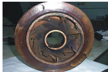
Roue fermée de la pompe centrifuge multicellulaire à axe horizontal en bronze attaquée par le phénomène de cavitation par érosion abrasive
