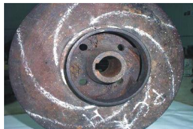
Roues fermées de la pompe centrifuge : D 2 = 230 mm D 1 = 200 mm, attaquées par l'érosion de cavitation
