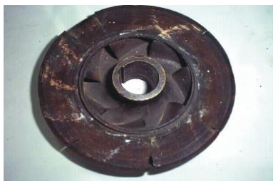
Roue fermée de la pompe multicellulaire immergée. Roue fermée de la pompe centrifuge attaquées par le phénomène de cavitation par abrasion
