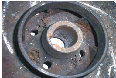
Roues fermées de la pompe centrifuge : D 2 = 230 mm D 1 = 200 mm, attaquées par l'érosion de cavitation
