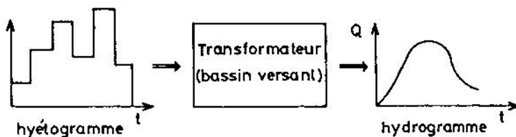
Figure 1 : Principe de transformation de l'hyétogramme de pluie en hydrogramme de ruissellement
