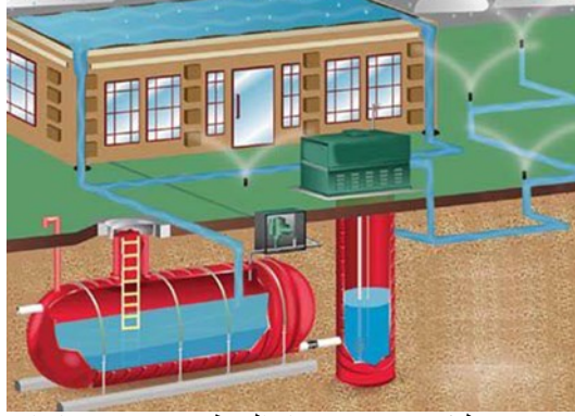
صورة رقم: رسم توضيحي لفكرة تجميع مياه السطوح، تصفيتها، استعمالها واستغلالها. مصدر أرشيف المؤلف.
