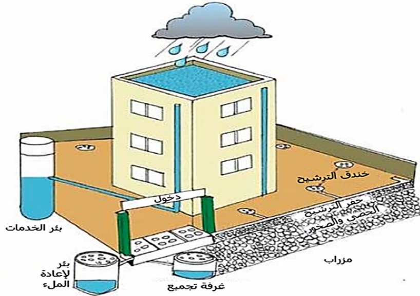
صورة رقم: رسم توضيحي لكيفية تجميع مياه الامطار من السطح وكذا الساحة الخارجية للمبنى نحو خزان ارضي ثم الاستعمال والاستغلال. كما يستعمل نظام smart في تشغيل العملية من بدايتها الى غاية الاستعمال [17]
