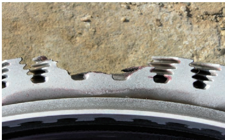
Fig. 3. Partie du disque HP endommagée
