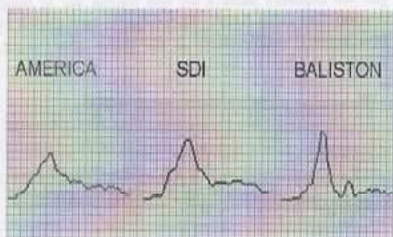
Figure 5 : Les courbes d'accélération du porte gant pour les trois gants
