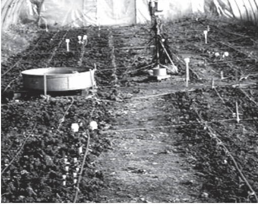
Figure 1 : Photo du dispositif de mesure installé au centre de la serre composé deux bacs d'évaporation (Class A et petit bac) et d'une Station météo automatique.
