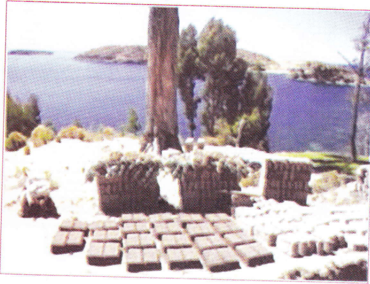
صورة 2: طريقة تجفيف الطوب في الشمس.
