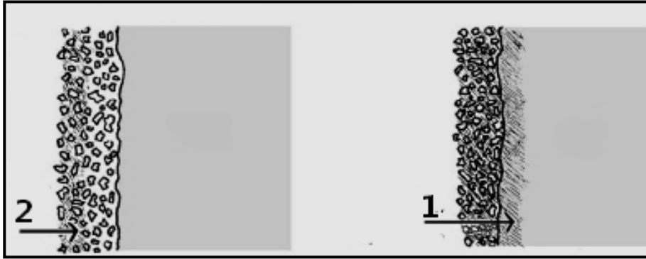
الشكل رقم 3: رسم توضيحي لمدى تغلغل المادة المقوية (1) تغلغل جيد (2) تغلغل ضعيف
