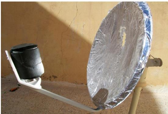
Figure 8. L'absorbeur est calorifugé.
