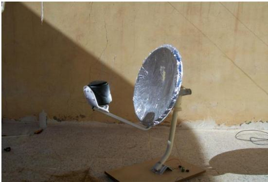
Figure 7. Le parabole est couverte par le papier d'aluminium.
