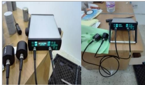
الصورة رقم (1): تبين جهاز قياس سرعة الموجة فوق الصّوتية
