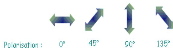
Il nous faut pouvoir détecter la polarisation des photons. Pour cela, on utilise un filtre polarisant suivi d'un détecteur de photons.
