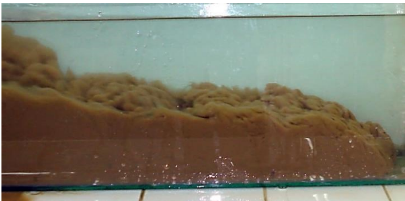
Figure 10 : Courant de turbidité au fond d'un canal avec une forte concentration en particules fines (Photo. Remini, 2015)
