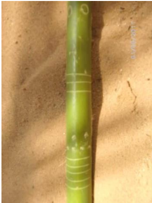
Figure 16 : La valeur mesurée est gravée sur une canne
