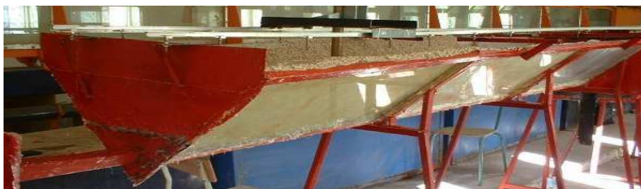
Figure 2 : Photographie du canal de mesure de section droite triangulaire, ayant servi à l'expérimentation.
