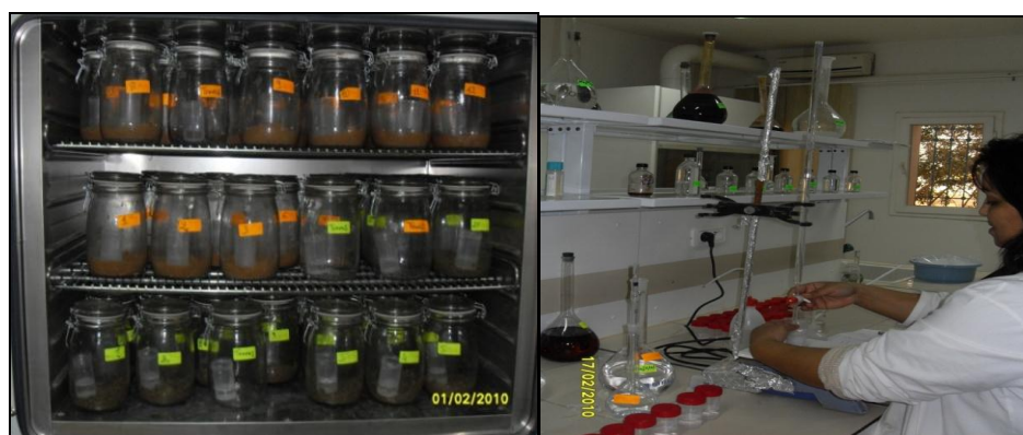
Figure 2.- Essai d'incubation (température: 28°C; humidité: 2/3Occ) et dosage du CO 2 dégagé par les échantillons de sols amendés
